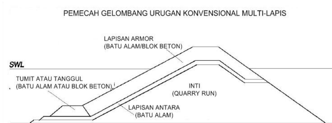
Gambar II.F.25 Pemecah gelombang urugan multi-lapis konvensional
